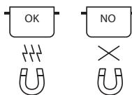
Používajte iba panvice a hrnce z feromagnetického materiálu vhodné na používanie na indukčných varných doskách:
