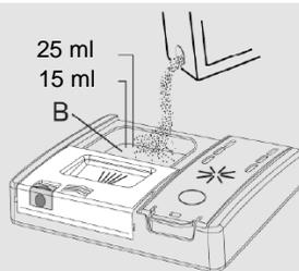
Pokud používáte tablety, měla by vám stačit jedna. Vložte TABLETY a dbejte na to, aby nepřekážely systému otevírání.
