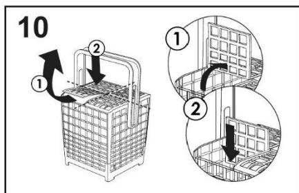
Výšku rukoväti košíka na príbor môžete nastaviť potiahnutím alebo zatlačením rukoväti. (obr. 11).
