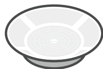
SITĂ DIN OȚEL INOXIDABIL (ÎN INTERIORUL BAZINULUI)
