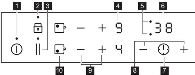
Cihazı çalıştırmak için sensör alanlarını kullanın. Gösterge ekranları, göstergeler ve sesler hangi fonksiyonların çalışmakta olduğunu bildirir.
