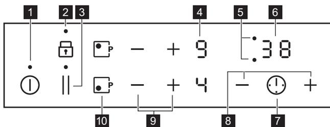
Urządzenie obsługuje się, dotykając pól czujników. Wyświetlacz, wskaźniki i sygnały dźwiękowe informują użytkownika o włączonych funkcjach.
