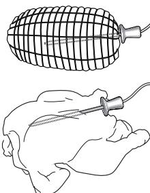
Precízne umiestnenie sondy je veľmi dôležité na dosiahnutie bezchybných výsledkov pečenia. Sondu zapichnite do časti, kde sa nachádza najviac mäsa. Vyhýbajte sa kostiam a častiam s tukom. Pri hydine sa sonda vkladá zboč do stredu pŕs, tak aby sa špička sondy nedostala do dutej časti. Ak má mäso rôznu hrúbku, pred vybratím z rúry skontrolujte, či sa upieklo rovnomerne. Koniec sondy pripojte do otvoru na pravej stene priestoru rúry. Pri zasunutí mäsovej sondy do priestoru rúry sa
