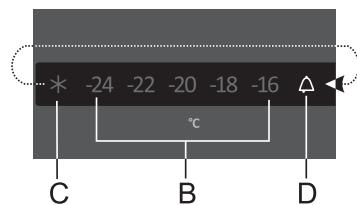
Ak je teplota v spotrebiči príliš vysoká, aktivuje sa akustický alarm (prerušovaný zvuk) a začne blikáť symbol **D**.
