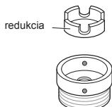
**3** Nasuňte adaptér na koniec prívodu vody, aby gumené tesnenie vytvorilo vodotesné spojenie. Utiahnite štyri upevňovacie skrutky.
