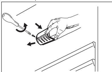
3. Înlocuiți becul cu unul cu caracteristici identice proiectat special pentru utilizarea în aparatele electrocasnice.
