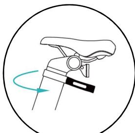
1. Opreți eBike-ul. Slăbiți cu forță clema tubului de șa.
