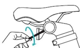
5. Потоа монтирајте го држачот на рефлекторот и заклучете ја завртката на држачот со фиксирање на задниот рефлектор во насока на стрелките на часовникот.
