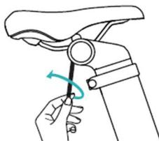
2. Otpustite zavrtanj za cev sedišta u smeru suprotnom od kazaljke na satu pomoću ključa H6.
