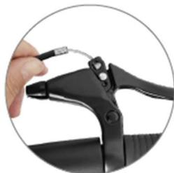
2. Ziehen Sie die Innenseele des Bremszuges heraus, stecken Sie den Zinkkopf in den Bremsseelenschnapper und stecken Sie den Schnapper in den Bremsgriff.
