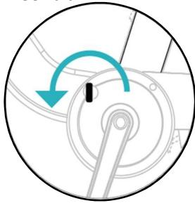
3. Stecken Sie den Batterieschlüssel ein und drehen Sie ihn um 180 Grad gegen den Uhrzeigersinn, um das Batterieschloss zu entriegeln.
