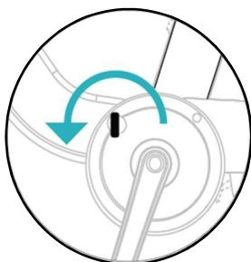
3. Introduceți cheia bateriei și rotiți-o cu 180 de grade în sens antiorar pentru a debloca dispozitivul de blocare a bateriei.
