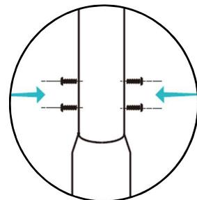
2. Wyrównaj otwory na śruby na kierownicy z otworami na śruby na łączniku rury pionowej.
