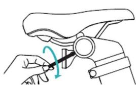
5. Apoi instalați suportul reflectorului și blocați șurubul suportului de fixare a reflectorului din spate în sensul acelor de ceasornic.
