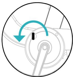
3. Vložte klíč od baterie a otočením o 180 stupňů proti směru hodinových ručiček odemkněte zámek baterie.
