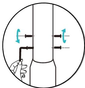
3. Folosiți cheia Allen H4 pentru a strânge în prealabil patru șuruburi cu cap semirotond M6\*10 (cu tampoane de glonț) pe cadru, apoi strângeți fiecare șurub alternativ în ordinea a două șuruburi inferioare și două șuruburi superioare până când toate șuruburile sunt strânse.
