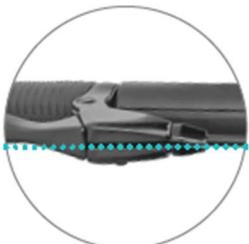
3. Rotirajte kočionu maticu kako biste osigurali da su razmak matice i razmak ručke na istoj liniji. Ispravite unutrašnju kočionu liniju i utisnite je u ručku i razmak matice, a spoljnu liniju priključite u rupu matice.
