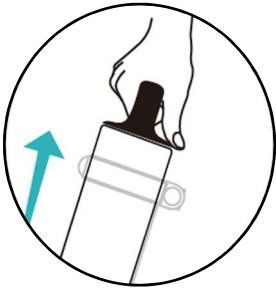
4. Helyezze be az akkumulátorkulcsot, és fordítsa el 180 fokban az óramutató járásával ellentétes irányba az akkumulátorzár feloldásához.
