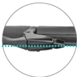
3. Otáčejte brzdovou maticí, abyste se ujistili, že mezera matice a mezera brzdové rukojeti jsou ve stejné linii. Narovnejte vnitřní brzdové vedení a zasekněte je do brzdové rukojeti a mezery mezi brzdovou maticí a vnější vedení zasuňte do otvoru v matici.
