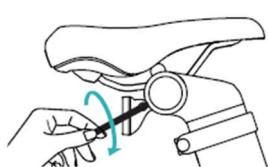
5. Następnie zainstaluj wspornik reflektora i zablokuj śrubę tylnego wspornika mocującego reflektor zgodnie z ruchem wskazówek zegara.
