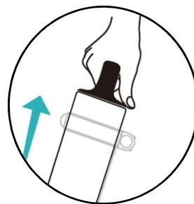
4. Ridicați bateria în sus cu forță pentru a o scoate. Puneti bateria în tubul de șa, apoi rotiți cheia la 180 de grade în sensul acelor de ceasornic pentru a bloca bateria și scoateți cheia.
