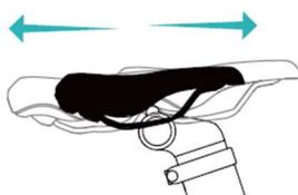
3. Șaua poate fi mutată înainte sau înapoi după ce șurubul tubului șeii este suficient de slăbit.
