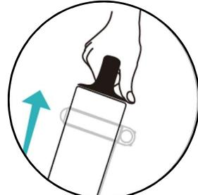
4. Akumulátor zvedněte silou směrem nahoru a vyjměte jej. Vložte baterii do sedlové trubky, otočte klíčkem o 180 stupňů ve směru hodinových ručiček, abyste baterii uzamkli, a klíč vyjměte.
