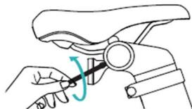
1. Pomocou kľúča H3 uvoľnite skrutku upevnenia zadného reflektora proti smeru hodinových ručičiek a vyberte reflektor.
