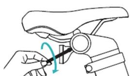
5. Ezután szerelje fel a fényvisszaverő tartóját, és rögzítse a hátsó fényvisszaverő rögzítő csavart az óramutató járásával megegyező irányba.
