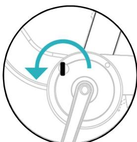
3. Włóż klucz baterii i obróć go o 180 stopni w kierunku przeciwnym do ruchu wskazówek zegara, aby odblokować blokadę baterii.
