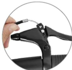
2. Izvucite unutrašnju jezgru kočionog kabla, priključite cink glavu na priključak jezgre kočnice, i stavite priključak u ručku.
