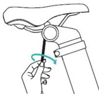
4. Nachdem Sie die Position eingestellt haben, schließen Sie die Schraube des Sattelrohrs im Uhrzeigersinn.
