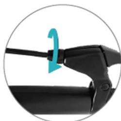
4. Strângeți piulița, slăbiți brațul basculant al frânei cu disc, instalarea este completă.
