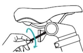
5. Bringen Sie dann die Reflektorhalterung an und drehen Sie die Schraube der hinteren Reflektorhalterung im Uhrzeigersinn fest.
