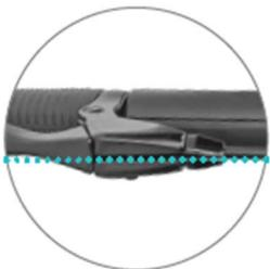
3. Zavorno matico obrnите tako, da sta vrzel med matico in vrzel med ročajem zavore na isti liniji. Izravnajte notranji zavorni vod in ga zataknite v zavorni ročaj in vrzel zavorne matice, zunanjji vod pa zataknite v luknjo matice.
