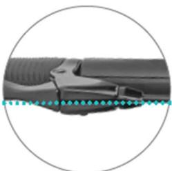
3. Okrenite maticu kočnice kako biste osigurali da razmak između matice i razmak ručke kočnice budu na istoj liniji. Ispravite unutarnju liniju kočnice, stavite ju u razmak između matice i ručke kočnice, te umetnите vanjsku dio u rupu matice.
