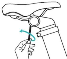
2. Lösen Sie die Schraube des Sattelrohrs mit einem H6-Schlüssel gegen den Uhrzeigersinn.
