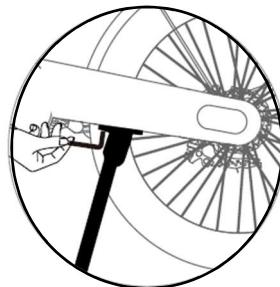
1. Prvo, pričvrstite nosač bicikla na okvir s dva M6\*16 vijka (s ravnim podlošcima)
