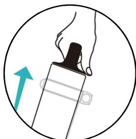
4. Stavite bateriju u cev sedišta, a zatim okrenite ključ za 180 stepeni u smjeru kazaljke na satu da biste zaključali bateriju i izvadite ključ.
