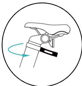
1. Schalten Sie das eBike aus. Lösen Sie die Sattelrohrschnalle mit Gewalt.
