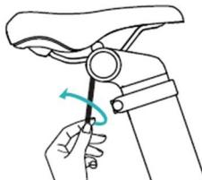
2. Poluzuj śrubę rury podsiodłowej w kierunku przeciwnym do ruchu wskazówek zegara za pomocą klucza H6.
