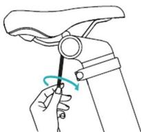
4. Nakon podešavanja položaja, stegnite vijak cijevi sjedala okretanjem u smjeru kazaljke na satu
