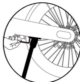
1. Nejprve předem utáhněte parkovací stojan na rámu dvěma šrouby s válcovou hlavou M6\*16 (s plochými podložkami).
