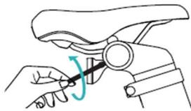
1. Koristite ključ H3 da labavo otpustite šaraf nosača zadnjeg reflektora, suprotno smeru kazaljke na satu i uklonite reflektor.
