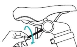
5. Nato namestite nosilec reflektorja in zaklenite vijak za pritrditev zadnjega nosilca reflektorja v smeri urinega kazalca.
