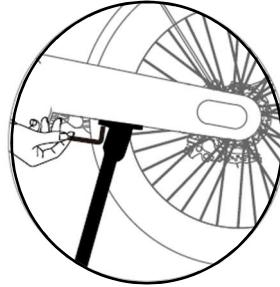
1. Mai întâi, strângeți în prealabil suportul de parcare pe cadru cu două șuruburi cu cap cilindric M6\*16 (cu plăcuțe plate).
