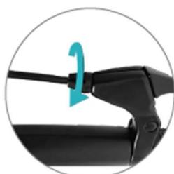
4. Dokręcić nakrętkę, poluzować wahacz hamulca tarczowego, montaż jest zakończony.
