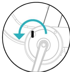
3. Vložte kľúč batérie a otočte ním o 180 stupňov proti smeru hodinových ručičiek, aby ste odomkli zámok batérie.
