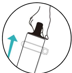
4. Heben Sie die Batterie mit Kraft nach oben, um sie zu entfernen. Setzen Sie die Batterie in das Sitzrohr ein, drehen Sie den Schlüssel um 180 Grad im Uhrzeigersinn, um die Batterie zu verriegeln, und ziehen Sie den Schlüssel ab.
