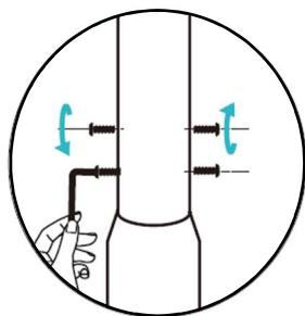
3. Pomocí imbusového klíče H4 předem utáhněte čtyři šrouby s půlkulatou hlavou M6\*10 (s kulovými podložkami) na rámu a poté utahujte jednotlivé šrouby střídavě v pořadí dva spodní šrouby a dva horní šrouby, dokud nebudou všechny šrouby utaženy.
