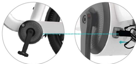
elektrokola. V opačném případě může dojít k poškození baterie nebo požáru a jinému nebezpečí, jakož i ztrátě záruky. **Montáž a nabíjení baterie**
