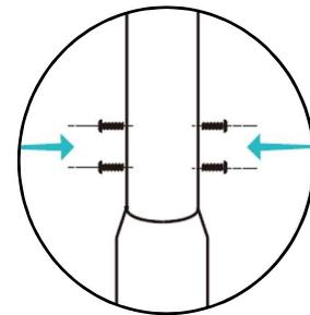
2. Aliniați găurile pentru șuruburi de pe ghidon cu găurile pentru șuruburi de pe cleștele tubului vertical.
