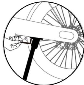
1. Najpierw należy wstępnie dok bagażnik postojowy do ramy za pomocą dwóch śrub z łbem cylindrycznym M6 (z płaskimi podkładkami).
