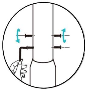
3. Ziehen Sie die vier Halbrundkopfschrauben M6\*10 (mit Kugeln) am Rahmen mit einem H4-Inbusschlüssel vor, und ziehen Sie dann jede Schraube abwechselnd in der Reihenfolge zwei untere Schrauben und zwei obere Schrauben an, bis alle Schrauben angezogen sind.
