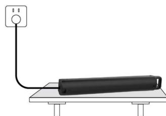
5. Po zakończeniu ładowania należy najpierw wyciągnąć wtyczkę zasilania AC, a następnie wyciągnąć wtyczkę podłączoną do akumulatora.
