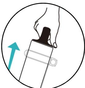
4. Podnieś baterię do góry, używając siły, aby ją wyjąć. Umieść akumulator w rurze podsiodłowej, a następnie przekręć kluczyk o 180 stopni zgodnie z ruchem wskazówek zegara, aby zablokować akumulator i wyjąć kluczyk.
