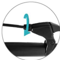
4. Zategnite maticu, otpustite nosač diska kočnice, instalacija je završena..
