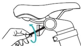
1. Pomocí klíče H3 povolte šroub upevnění zadního reflektoru proti směru hodinových ručiček a reflektor sejměte.
