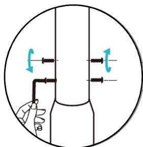
3. Pomocou imbusového kľúča H4 predbežne utiahnite štyri skrutky s polkruhovou hlavou M6\*10 (s guľôčkovými podložkami) na ráme, potom striedavo uťahujte každú skrutku v poradí dve spodné skrutky a dve horné skrutky, kým nebudú všetky skrutky utiahnuté.
