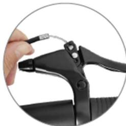
2. Vytáhněte vnitřní jádro brzdového lanka, zasuňte zinkovou hlavici do západky brzdového jádra a zasuňte zátku do rukojeti brzdy.
