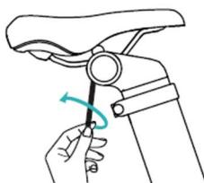
2. Pomoću ključa H6 odvrnите vijak cijevi sjedala suprotno smjeru kazaljke na satu
