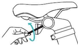
1. S ključem H3 sprostite vijak za pritrditev zadnjega reflektorja v smeri urinega kazalca in odstranite reflektor.
