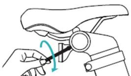
5. Poté namontujte držák reflektoru a zajistěte zadní upevňovací šroub reflektoru ve směru hodinových ručiček.
