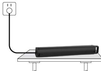
Nachdem der Akku vollständig entladen ist, beträgt die einmalige Ladezeit 4 bis 5 Stunden, und nachdem die Ladekontrollleuchte von Grün auf Rot wechselt, ist die Leistungskapazität des Akkus grundsätzlich ausreichend.
