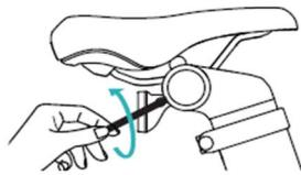
1. Lösen Sie die Schraube der hinteren Reflektorhalterung mit dem H3-Schlüssel gegen den Uhrzeigersinn und entfernen Sie den Reflektor.
