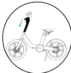
1. Postavite sklop upravljača na ram bicikla
