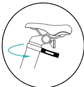
1. Wyłącz rower elektryczny. Poluzuj zacisk rury podsiodłowej siłą.
