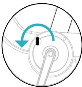
3. Helyezze be az akkumulátorkulcsot, és fordítsa el 180 fokban az óramutató járásával ellentétes irányba az akkumulátorzár feloldásához.
