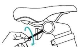
5. Zatim postavite držać reflektora i zaključajte zavrtanj zadnjeg držaća reflektora u smeru kazaljke na satu.
