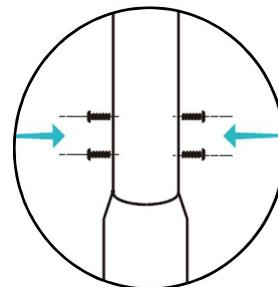
2. die Schraubenlöcher am Lenker mit den Schraubenlöchern am Gabelkopf des Vertikalrohrs ausrichten
