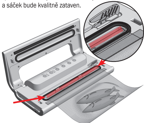
Obrázek 4: Během procesu vakuového balení musí být okraj sáčku ve středu vakuového kanálku.
