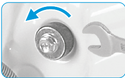
Lösen Sie die 4 Transportschrauben mit einem Schraubenschlüssel.
