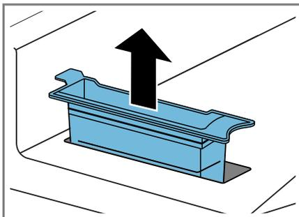
2. Vyčistite filter pod teplou tečúcou vodou alebo v umývačke riadu.
