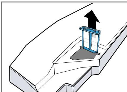
3. Vyčistite filter pod teplou tečúcou vodu alebo v umývačke riadu.
