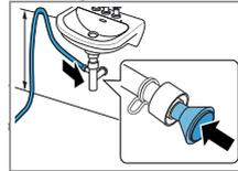
Miesto pripojenia zaistite hadicovou objímkou (12 – 22 mm). Odtokovú hadicu vody upevnite pomocou vedenia hadice vo výške minimálne 80 cm a maximálne 100 cm.
