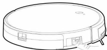
**Zapnout:** přepněte spínací tlačítko do pozice ON (1)
