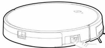
**Zapnutie:** prepnite spínacie tlačidlo do pozície ( **I** )
