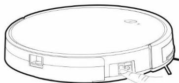
**Pornire:** comutați butonul de pornire/oprire în poziția ON (1)
