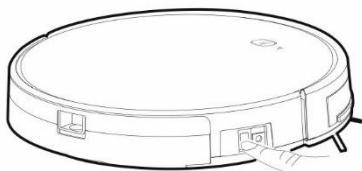
**Vklop:** stikalo za vklop premaknite v položaj ON (I)
