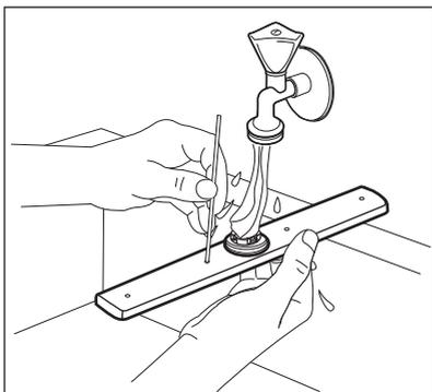
4. Pentru a instala brațul stropitor la loc, introduceți elementul de montare în brațul stropitor și fixați-l în conductă rotindu-l spre stânga. Asigurați-vă că elementul de montare se blochează în locul său.
