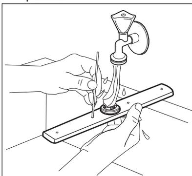
4. Na opätovnú inštaláciu sprchovacieho ramena vložte montážny prvok do sprchovacieho ramena a upevnite ho v kanáliku otočením proti smeru hodinových ručičiek. Skontrolujte, či montážny prvok zapadol na svoje miesto.
