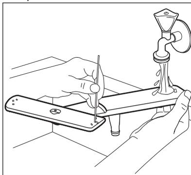
3. Sprchovacie rameno namontujte späť jeho zatlačením nadol.
