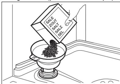
4. Scuturați cu atenție de mânerul pălniei pentru a pica și ultimele granule în interior.
