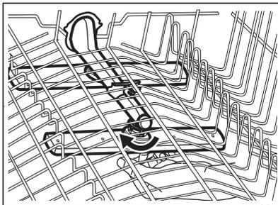
3. Sprchovacie rameno umyte pod tečúcou vodou. Z otvorov odstráňte čiastočky nečistôt pomocou predmetu s tenkým hrotom, napr. špáradla.
