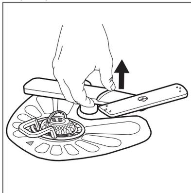
2. Sprchovacie rameno umyte pod tečúcou vodou. Z otvorov odstráňte čiastočky nečistôt pomocou predmetu s tenkým hrotom, napr. špáradla.
