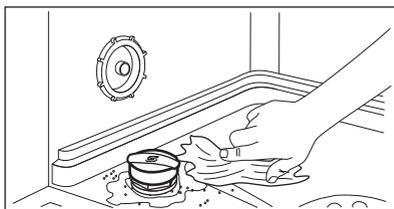
6. Zásobník na soľ zatvorte otočením veka zásobníka doprava.
