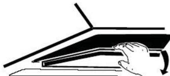
Legen Sie den Aktivkohlefilter in das Gerät und drehen Sie ihn im Uhrzeigersinn. Wiederholen Sie das gleiche auf der anderen Seite.
