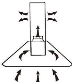
V tem primeru v napo vstavite filter z aktivnim ogljem, ki zadrži vonjave. Najprej morate sneti filter za maščobe, nato pa lahko vstavite ogljeni filter. Potisnite na zapah in potegnite filter za maščobe navzdol.
