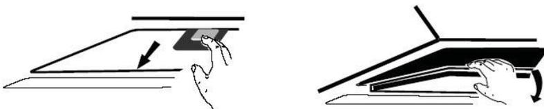
Namjestite aktivni ugljeni filter na motor nape i učvrstite ga okretanjem udesno. Ponovite isto i na drugoj strani.
