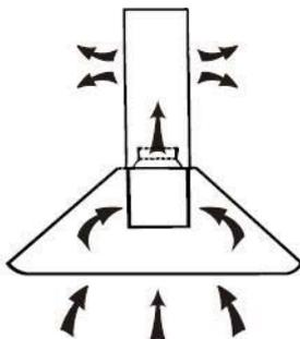
De koolfilter kan gebruikt worden om geuren op te vangen. Om de koolfilter aan te leggen moet u eerst de vetfilter van de afzuigkap halen. Hiervoor dient u op de vergrendeling te drukken en de vetfilter naar beneden te trekken.
