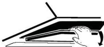
Inserire il filtro carbone attivo sul lato del motore e girare in senso orario. Ripetere la stessa cosa sull'altro lato.
