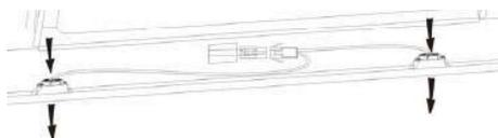
Odłączyć przewód elektryczny i wyjąć oprawki z przewodami z okapu. Ważne: nie jest możliwa wymiana samej żarówki, trzeba zmienić żarówkę razem z oprawkami i przewodami (żarówka LED MAX 1.5W) Zamontować nowe żarówki i przewody w okapie. Podłączyć przewody elektryczne.
