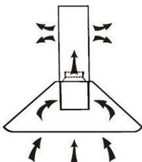
Il filtro al carbone attivo può essere utilizzato per eliminare gli odori. Per installare il filtro al carbone attivo, bisogna prima rimuovere il filtro anti-grasso premendo il gancio di sblocco.
