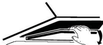
Montati filtrul de carbon activ în unitate și rotiți-l în sensul acelor de ceasornic. Repetați operațiunea în partea cealaltă.
