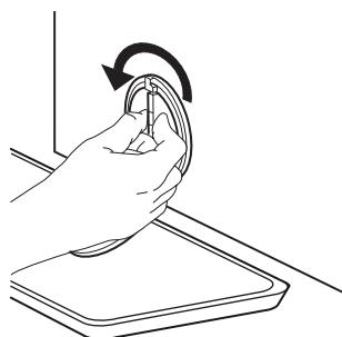
4. Odstráňte filter: Pod vodný filter umiestnite bavlnenú handru, ktorá môže absorbovať malé množstvo zvyšnej vody. Potom vyberte filter otáčaním proti smeru hodinových ručičiek.
