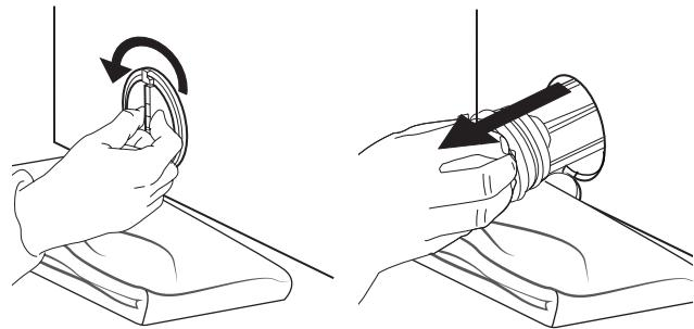
5. Vyčistite filter: odstráňte zvyšky z filtra a očistite ho pod tečúcou vodou.
