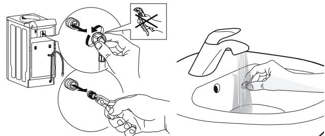
4. Vložte sitkový filter na pôvodné miesto. Pripojte hadicu späť k vodovodnému ventilu a práčke. Na pripojenie hadice nepoužívajte náradie. Otvorte ventil prívodu vody a ubezpečte sa, či sú spojenia tesné.
