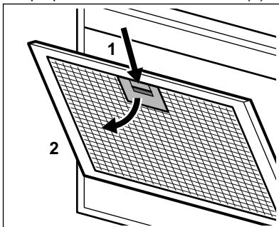
2. Înclinați ușor partea frontală a filtrului în jos (2), după care trageți. Repetați primii doi pași pentru toate filtrele.
