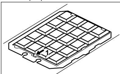
3. Při instalaci nového filtru provedte stejný postup v opačném pořadí. V každém případě je nutné měnit filtry nejméně každé čtyři měsíce.
