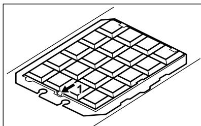
3. Führen Sie zum Einbau des neuen Filters die gleichen Schritte in umgekehrter Reihenfolge durch.
