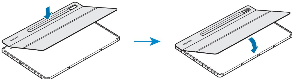
**3** Poravnajte priključke tableta i tipkovnice, a zatim tipkovnicu pričvrstite na tablet.
