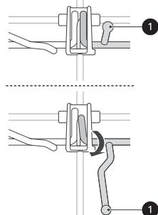
Stojany na sklenice poskytují podporu pro skleničky s dlouhou stopkou.
