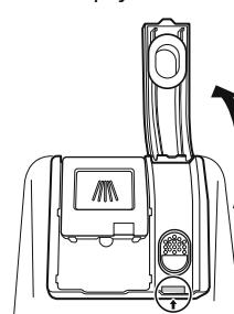
**2** Přidejte tekuté leštidlo po čáru maximálního naplnění. Leštění by se mělo při plnění usadit v dávkovači. V opačném případě mohou mít
