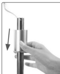
Provlečte kabel, vedoucí z trubice 2, otvorem, umístěným na spodní straně senzoru detekce směru větru, směrem nahoru.
