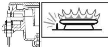
Tepelné zariadenie aktivuje bezpečnostný mechanizmus ak horné horáky zhasnú v prípade pretečenia kvapaliny a okamžite vypne plyn.
