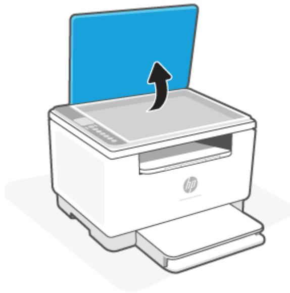
2. Vložte originál tlačenu stranou nadol a zarovnajte ho s označením v ľavom zadnom rohu skla.
