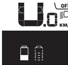
Jei „eBike“ dviračiuje su dviem įdėtais akumuliatoriais yra įkraunami abu akumuliatoriai, tai ekrane rodomas abiejų akumuliatorių įkrovimo procesas (paveikslėlyje šiuo metu įkraunamas kairysis akumuliatorius). Kuris iš abiejų akumuliatorių yra įkraunamas šiuo metu, rodo ant akumuliatoriaus mirksintis rodmuo.
