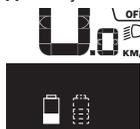
Ak sa na eBike s dvomi vloženými akumulátormi nabíjajú oboja akumulátory na bicykli, potom sa na displeji zobrazuje postup nabíjania oboch akumulátorov (na vyobrazení sa nabíja práve ľavý akumulátor). To, ktorý akumulátor sa práve nabíja, môžete zistiť podľa blikajúceho indikátora na akumulátore.
