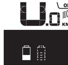
Ja vienā elektrovelosipēdā ir ievietoti divi akumulatori un abi šie akumulatori tiek uzlādēti tieši uz velosipēda, uz displeja tiek parādīta abu akumulatoru uzlādes gaita (attēlā tiek parādīta kreisā akumulatora tiešā uzlāde). To, kurš no abiem akumulatoriem tieši tiek uzlādēts, parāda mirgojošs indikators uz akumulatora.
