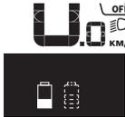
Kui kahe paigaldatud akuga eBike'il laetakse mõlemat akut jalgrattal, siis kuvatakse ekraanil mõlema aku laadimise edenemist (joonisel laetakse parajasti vasakut akut). Parajasti laetava aku näit vilgub.
