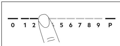
Keď položíte na zónu riad a nastavíte varný stupeň, zostane nezmenený do 2 minút od odobratia riadu. Ovládací pásek a ukazovateľ varnej zóny blikajú 2 minúty. Ak opäť položíte riad na varnú zónu v rámci tohto času, opätovne sa zapne varný stupeň, inak sa varná zóna vypne.
