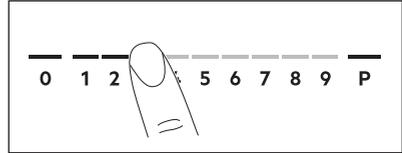
După ce ați pus un vas pe zonă și setați nivelul de căldură, acesta rămâne la fel timp de 2 minute după ce îndepărtați vasul. Bara de comandă și indicatorul zonei de gătit clipește timp de 2 minute. Dacă puneți din nou vasul pe zona de gătit în acest timp, nivelul de căldură se reactivează, altfel, zona de gătit se dezactivează.
