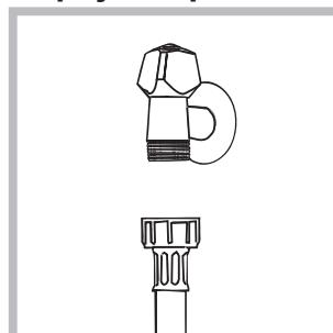
1. Pripojte prívodnú hadicu jej zaskrutkováním ku kohútiku so studenou vodou s hrndlom so závitom 3/4" (viď obrázok). Pred pripojením hadice nechajte vodu odtieckať, až kým nebudete číra.
