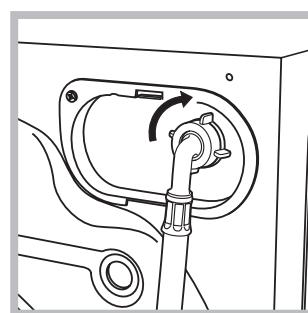
2. A vízbevezető cső csatlakoztatásához csavarozza a csövet a mosógép hátoldalán jobbra fent található vízbemeneti csonakra (lásd ábra)!
