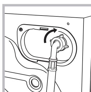
2. Pripojte prítokovú hadicu k práčke, jej zaskrutkováním k príslušnej prípojke na vodu, umiestnej vpravo hore (viď obrázok).
