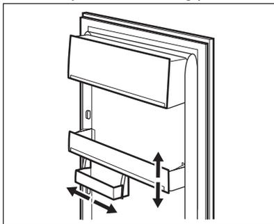
Ten model urządzenia wyposażono w regulowany pojemnik, który można przesunąć na boki.
