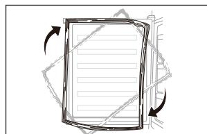
12. Vráťte dvere späť. Než definitívne dotiahnete skrutky, skontrolujte, či dvere horizontálne aj vertikálne doliehajú a či tesnenie po všetkých stranach správne dosadá.
