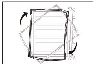
12. Helyezze vissza az ajtót! Mielőtt teljesen rögzíti a csavarokat, ellenőrizze az ajtó függőleges és vízszintes oldalát és a tömítés megfelelő működését!
