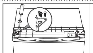
13. Nasaděte horní kryt a upevněte jej pomocí 2 šroubů na zadní straně.
