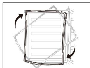
12. Vraťte dveře zpět. Než definitivně dotáhnete šrouby, zkонтrolujte, zda dveře horizontálně i vertikálně lícují a zda těsnění po všech stranách správně dosedá.
