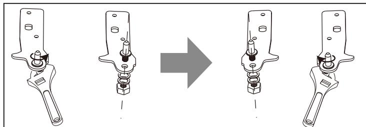
10. Instalujte konzoly na spodní závěs. Vraťte zpět obě nastavitelné nožky
