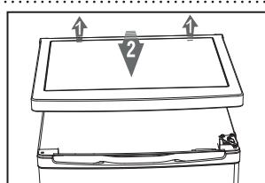
3. Odšroubujte horní závěs, odejměte dveře a položte je na měkkou podložku, aby se nepoškrábaly.
