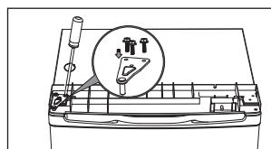
13. Nasadte horný kryt a upevnite ho pomocou 2 skrutiek na zadnej strane.
