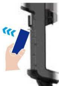
7. Navlečte si gumové rukavice a vyberte batériu.
