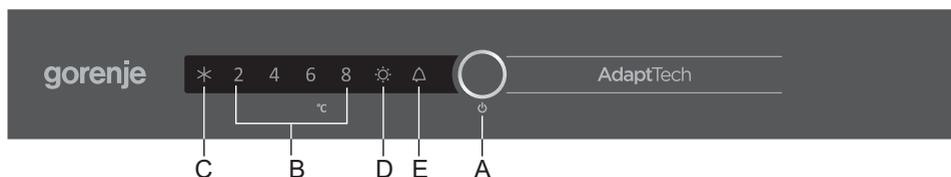
**A** Vypnutie/zapnutie spotrebiča, nastavenie teploty a tlačidlo doplnkovej funkcie
