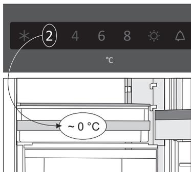
Aby bola teplota v zásuvke **ZeroZone** 0 °C, odporúčame nastaviť teplotu chladničky na 4 °C. Teplota v zásuvke **ZeroZone** môže klesnúť pod 0 °C; umiestnite preto potraviny citlivé na mrazenie do hornej časti chladničky.
