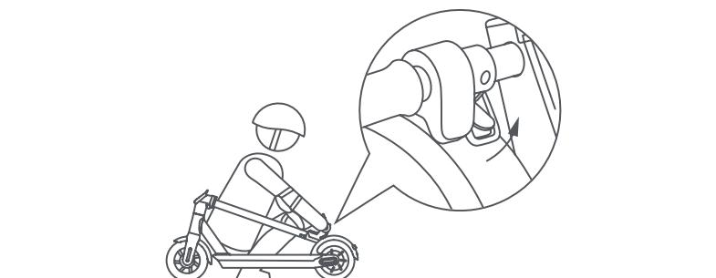
Assurez-vous que la trottinette électrique a bien été éteinte. Saisissez le guidon avec une main, puis poussez le levier et alignez le crochet du guidon au crochet situé sur le plateau.
