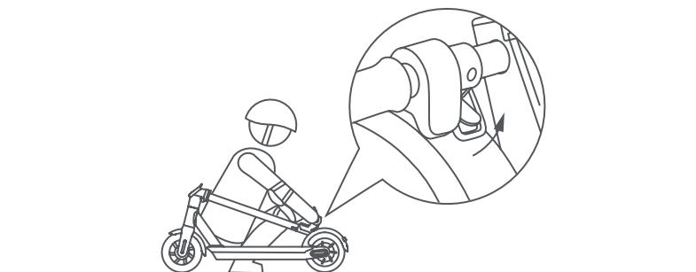
Stellen Sie sicher, dass der Elektroroller ausgeschaltet ist. Halten Sie die Lenkerstange mit der Hand fest, ziehen Sie dann den Hebel und richten Sie den Lenkerhaken mit dem Haken am Trittbrett aus.
