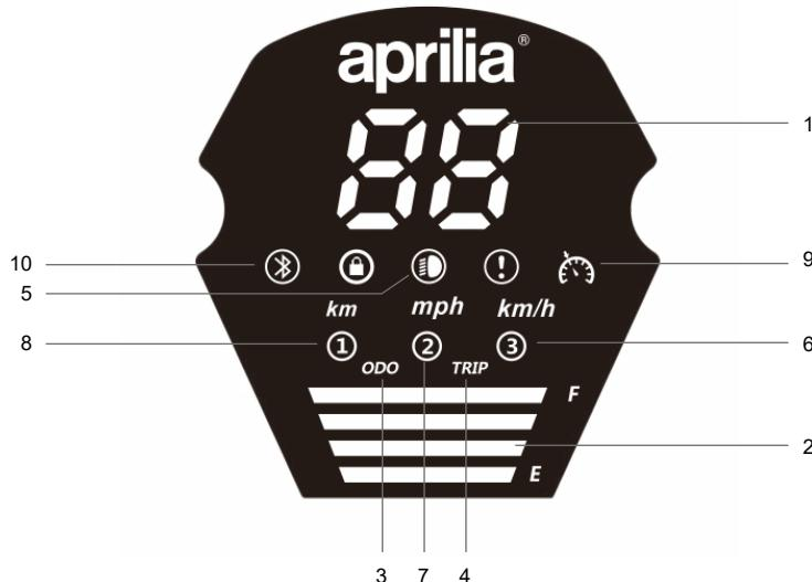
1. Brzinomer: prikazuje brzinu trotineta u realnom vremenu
