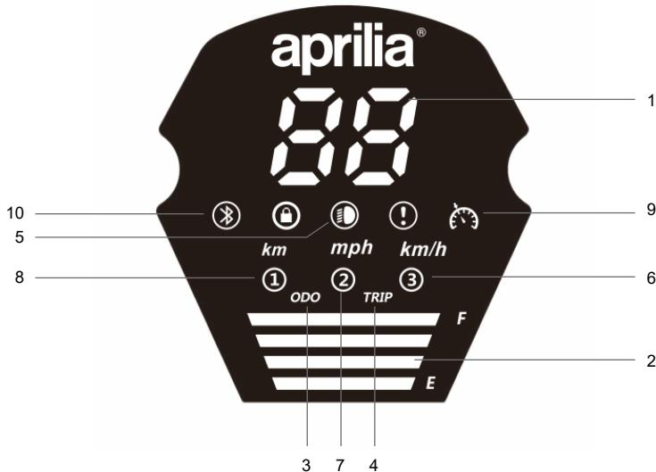
1. Tachometer: Zeigt die aktuelle Geschwindigkeit des Rollers an.
