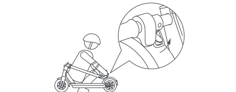
Uistite sa, že e-kolobežka bola vypnutá. Uchopte rukou riadiacu tyč riadiidel, potom zatiahnite za páku a zarovnajte háčik riadiidel s hákom umiestneným na nášlapnej doske.
