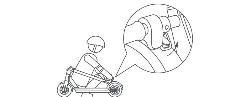
Ujistěte se, že e-koloběžka byla vypnuta. Uchopte řídící tyč řídítka rukou, poté zatáhněte za páku a srovnejte háček řídítka s hákem umístěným na nášlapní desce.
