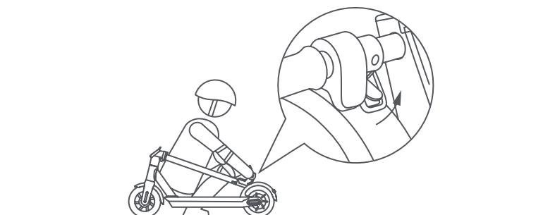
Proverite da li je trotinet isključen. Uhvatite rukom nosač upravljača, zatim povucite ručicu i poravnajte kuku upravljača sa kukom koja se nalazi na gazištu.
