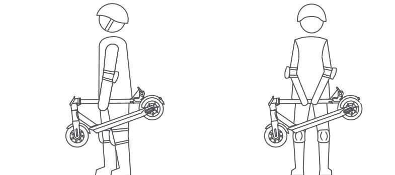
Klappen und halten Sie die Lenkerstange mit einer oder beiden Händen.
