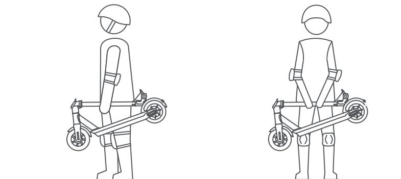
Sklopte a přidržte řídící tyč řídítka jednou nebo oběma rukama.
