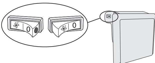
Ked' je ventilátor a ionizátor zapnutý, rozsvieti sa červená bodka na spínači.
