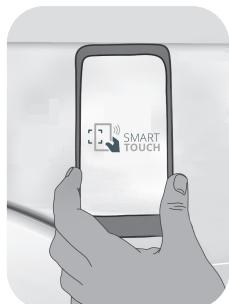
**Umístěte smartfon tak, že NFC anténa na zadní straně odpovídá pozici Smart Touch logu spotřebiče (viz obrázek níže).**
