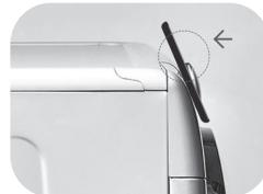
Якщо ви не знаєте позицію вашої NFC антени, перемістіть смартфон в круговому русі над логотипом **Smart Touch (Смарт Сенсор)**, поки програма не підтвердить з'єднання. Для того, щоб передача даних, була успішною, важливо **УТРИМУВАТИ СМАРТФОН НАВПРОТИ ПРИЛАДОВОЇ ПАНЕЛІ ПРОТЯГОМ ДЕКІЛЬКОХ СЕКУНД**; повідомлення на пристрой проінформує про успішний результат операції.
