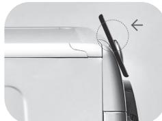
**Pokud neznáte pozici NFC antény, krouživými pohyby lehce pohybujte chytrým telefonem nad logem Smart Touch dokud aplikace nepotvrdí připojení. Aby byl přenos dat úspěšný, je nutné **UDRŽOVAT CHYTRY TELEFON V BLÍZKOSTI OVLÁDACÍHO PANELU BĚHEM CELÉHO NĚKOLIKAVTERINOVÉHO PŘIPOJENÍ**. Následně Vás bude zařízení informovat o správném výsledku operace a oznámí Vám, že je možné přesunout se s chytrým telefonem kamkoliv.**
