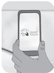
**Așezați telefonul în aşa fel încât antena NFC de pe spate să corespundă cu logo-ul Smart Touch de pe mașina de spălat** (vezi imaginea de mai jos).
