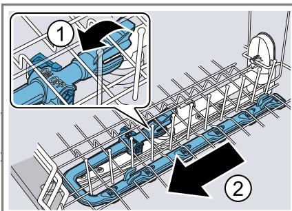
3. Posuvný vypínač nastavte do polohy ON.
