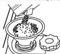
Dbajte, aby bol uzáver pevne zatiahnutý, aby sa počas umývacieho programu nedostal do zásobníka umývací prostriedok (mohlo by to nenapraviteľne poškodiť zmäkčovač vody).
