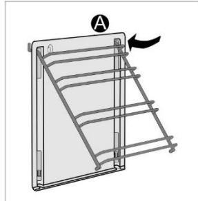
Vodiče namontujte na katalytickej vložke. Horná časť vodičov sa musí namontovať do horných otvorov "A" na katalytickej vložke.
