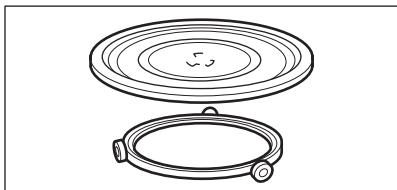
Skleněná varná podložka a vodicí lišta válečků.
